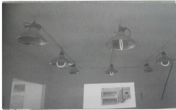
타이머를 설치해 카본히터의 성능을 테스트하는 과정
